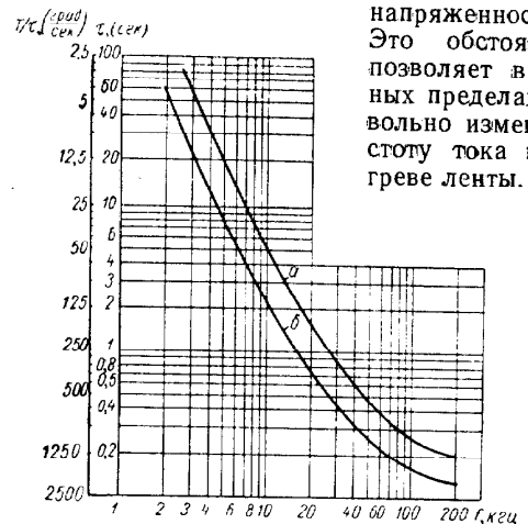
Рис. 4. Графики зависимости скорости нагрева ленты от частоты тока: а — лента толщиной 0,15 мм; б — лента толщиной 0,25 мм.
